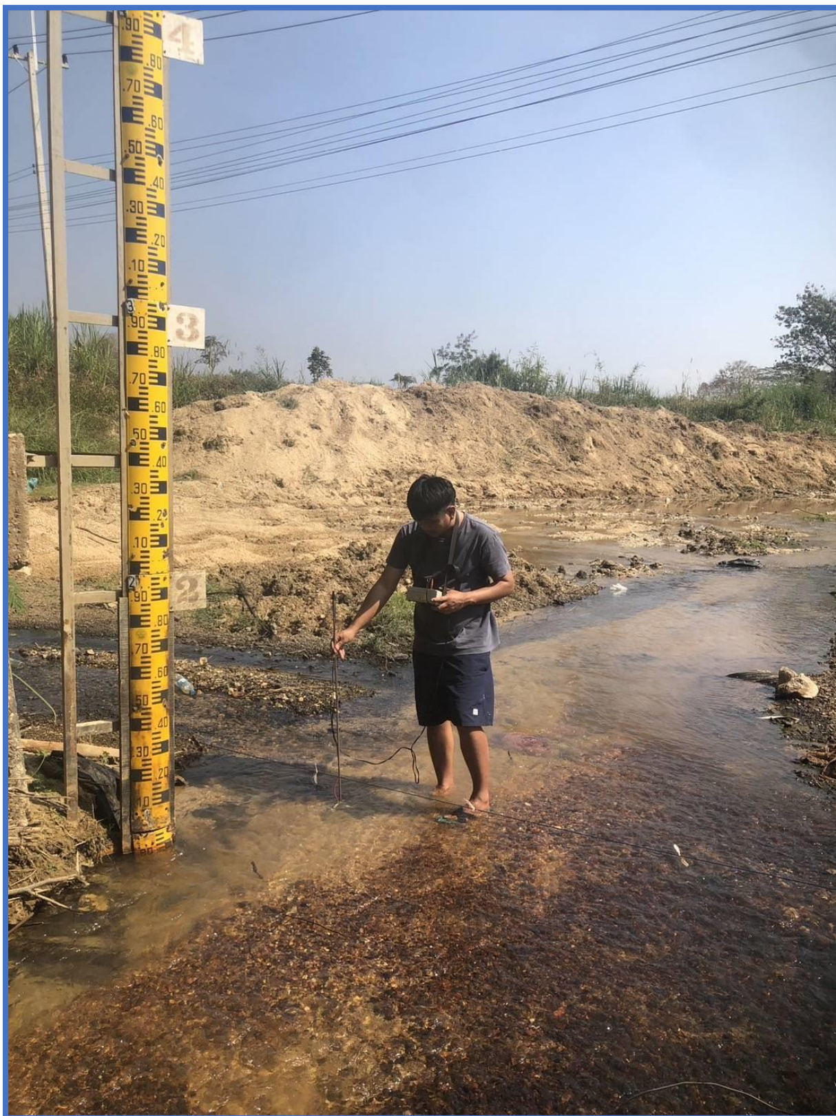
รูปที่ 6 ทำการสำรวจระดับน้ำ, ปริมาณน้ำ และตะกอนแขวนลอย ที่สถานี Tw.28 น้ำแม่ตุ๋ย บ้านปลายนา อ.เมืองปาน จ.ลำปาง (ทำโครงการอ่างเก็บน้ำแม่หนึ่ง อันเนื่องมาจากพระราชดำริ จังหวัดลำปาง)
